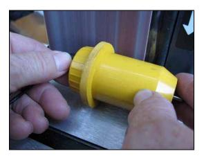
Figure 6: Sanding the Cut Edge
